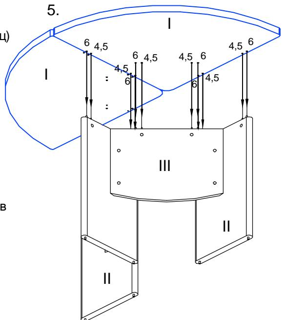
В зависимости от дизайна расставить нижние секции (без столешниц) на предполагаемом месте монтажа стола. Соединить их соединительными планками и боковинами в один единый каркас с помощью соединительных шкантов (6) и дюбелей (5) со стяжками эксцентриками (1).
